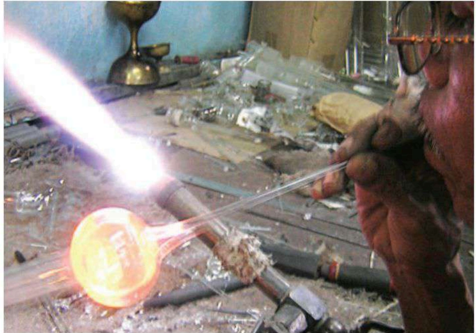
الشكل ٩ يبدأ الزجاج في الليونة تدريجياً عند تسخينه بدلاً من انصهاره وتحوله إلى سائل. ويستخدم صانعو الزجاجيات هذه الميزة في تشكيل الزجاج.
